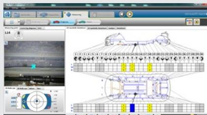
Appuyez sur le bouton en forme de cible pour effectuer la mesure automatique. La fonction ASP affiche automatiquement des photos des points de mesure sur l'écran au fur et à mesure que le bras de mesure se déplace d'un point à un autre
