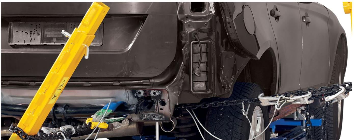
Grâce à des capteurs dans chaque articulation et à une tête de mesure, le bras de mesure communique sans fil avec **Vision2**, fournissant des données de mesure en temps réel, trois fois par seconde.
